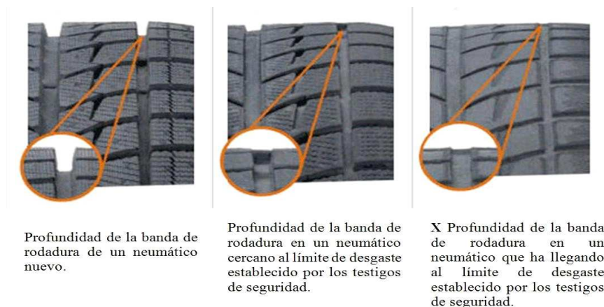
Figura 5.1 Evidencia de desgaste en testigo de seguridad en un neumático.
